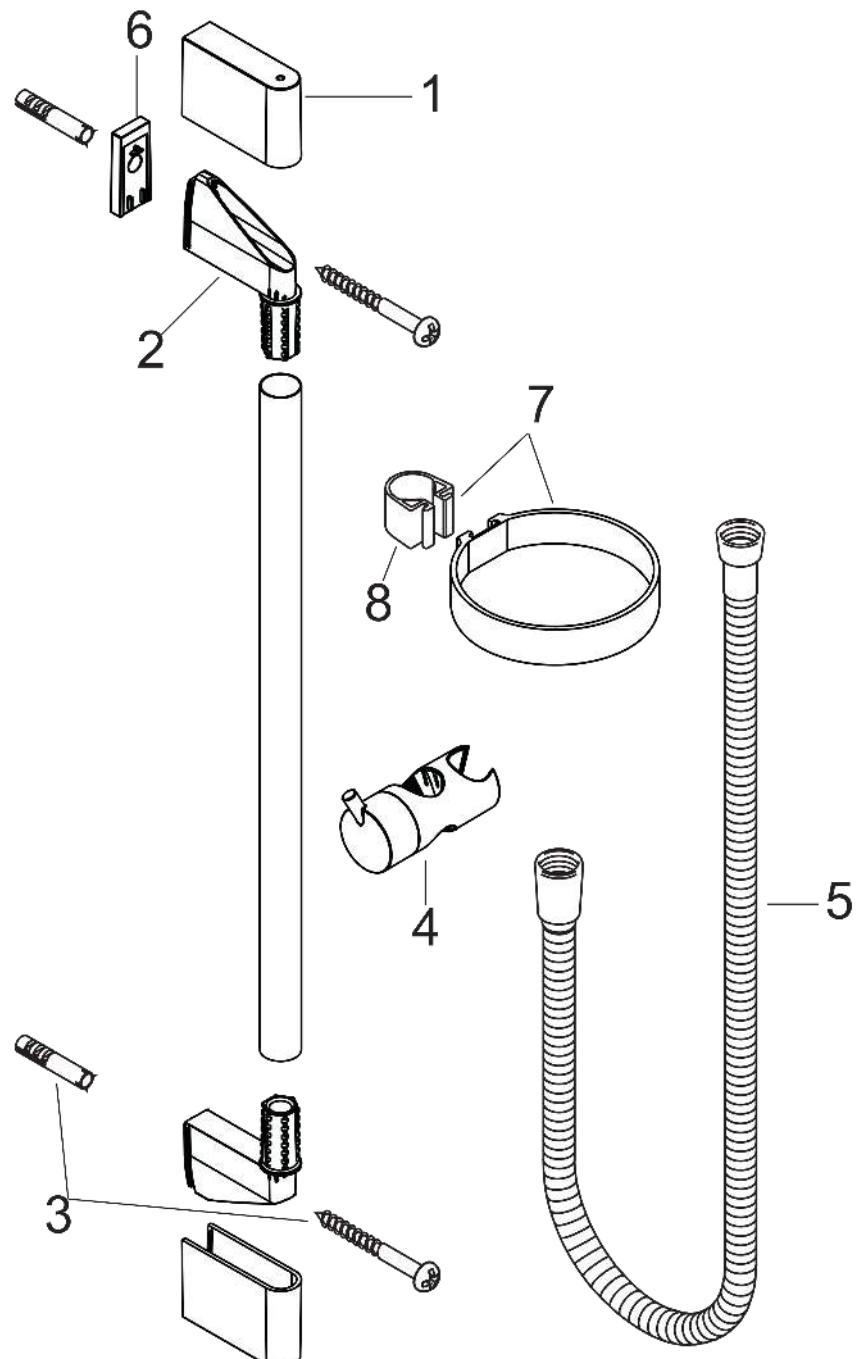
**Unica****Brausenstange Crometta 90 cm mit Brausenschlauch**Oberfläche: **Chrom** Artikelnummer: **27614000****Ersatzteilliste**
