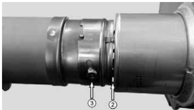
Abb. 4: Einstellung Rezirkulationsmaß R ② (Abbildung beispielhaft)
