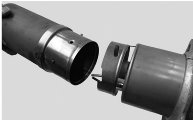
Abb. 3: Montage Keramikrohr auf Stützrohr
