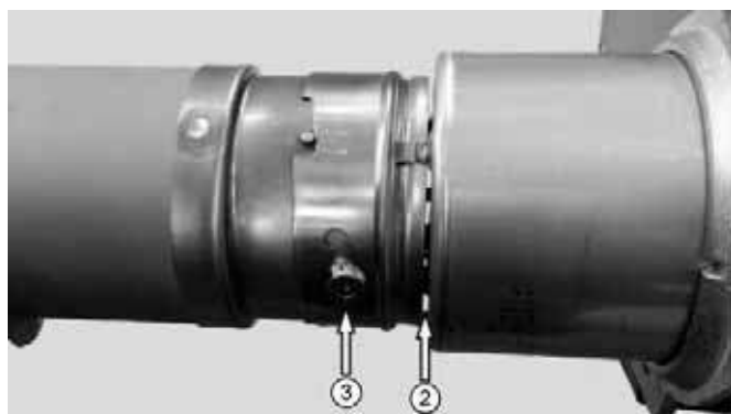
Abb. 4: Einstellung Rezirkulationsmaß R ② (Abbildung beispielhaft)
