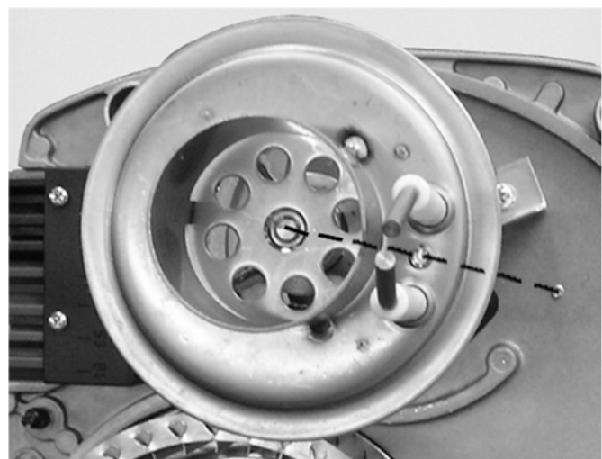
Abb. 40: Mischsystempositionierung und Ausrichtung Zündelectrode
