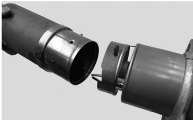
Abb. 3: Montage Keramikrohr auf Stützrohr
