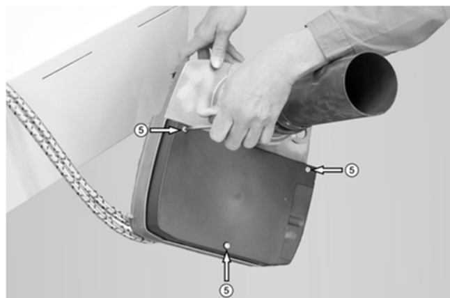
Fig. 2: Smontaggio del silenziatore di aspirazione
