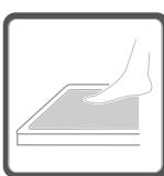
De antisliplaag wordt permanent aangebracht op het oppervlak van sanitair acryl (PMMA) en gegoten mineraalsteen en zorgt voor maximale veiligheid en optimaal comfort bij het baden. Het esthetische patroon met een fijne structuur geeft de badkamer een nieuwe uitstraling. De laag heeft een vlak oppervlak, waardoor een douche eenvoudiger kan worden gereinigd. Het nemen van een douche wordt zowel aangenaam als veilig.
