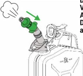
Öffnen Sie durch Drücken den Verschluss des des Ausgießers, um den Druck im Kanister auszugleichen.
