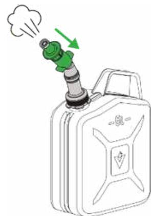
Öffnen Sie durch Drücken den Verschluss des des Ausgießers, um den Druck im Kanister auszugleichen.
