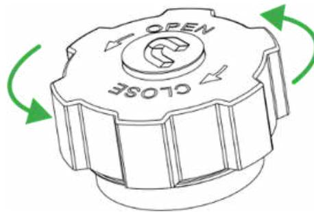
Schrauben Sie den Deckel des Kanisters gegen den Uhrzeigersinn auf.
