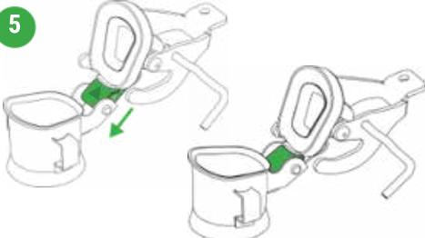
Schieben Sie das Scharnier nach unten, damit der Deckel in der Position gehalten wird.
