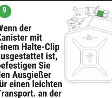
Wenn der Kanister mit einem Halte-Clip ausgestattet ist, befestigen Sie den Ausgießer für einen leichten Transport. an der Halterung.</p>                                           |
