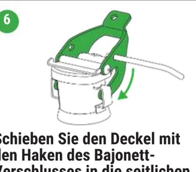
Schieben Sie den Deckel mit den Haken des Bajonett-Verschlusses in die seitlichen Halterungen der Öffnung. Danach drücken Sie den Deckel vollständig bis zum Anschlag herunter.</p> |
