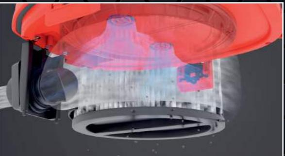
Er besteht aus zwei voneinander unabhängigen Filterkammern, die nacheinander abgereinigt werden. Saugstrom und Saugleistung bleiben dadurch auch während der Abreinigung auf konstant hohem Niveau, was eine permanente Absaugung garantiert.
