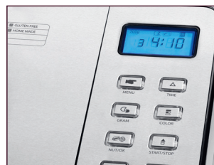
Elektronisches Bedienfeld mit LCD-Display (blau beleuchtet)
